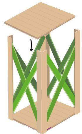
**4** Nun werden wir die vorbereiteten Teile zusammenbauen. An den Boden kleben wir die 4 seitlichen Kanten an und verbinden sie mit jeweils 2 roten Holzstäbchen (25 cm) in diagonaler Richtung. Oben befestigen wir die Deckplatte.
